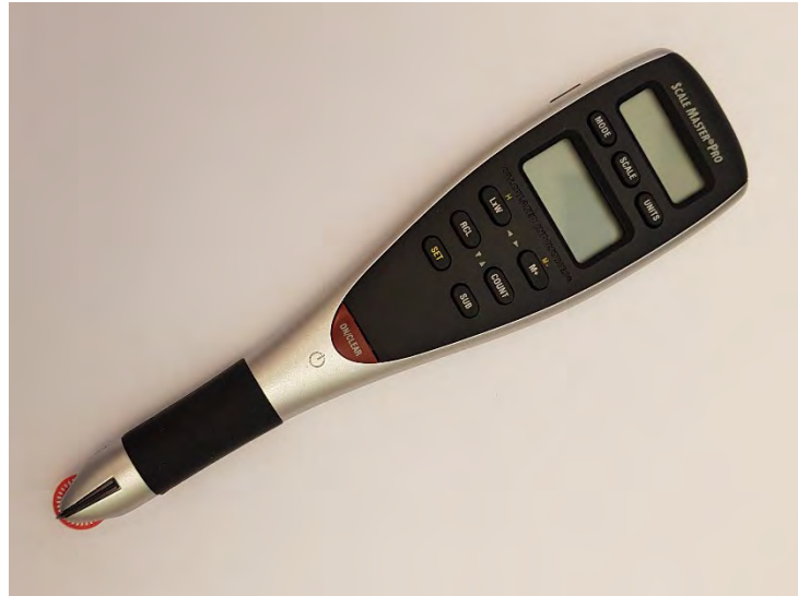
Figure 2.9 – Digitalt mätjul (Scale Master Pro) för att mäta spricklängden.
