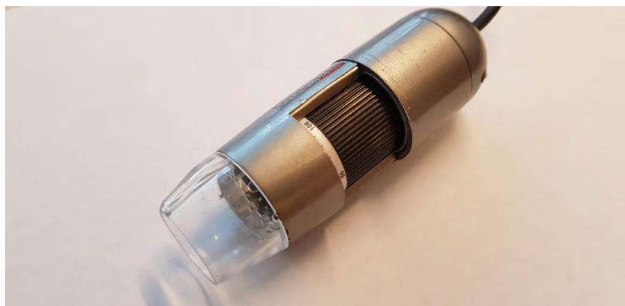
Figur 2.7 – Dino Lite AM-413T Pro digital mikroskop för mätning av sprickbredd.
