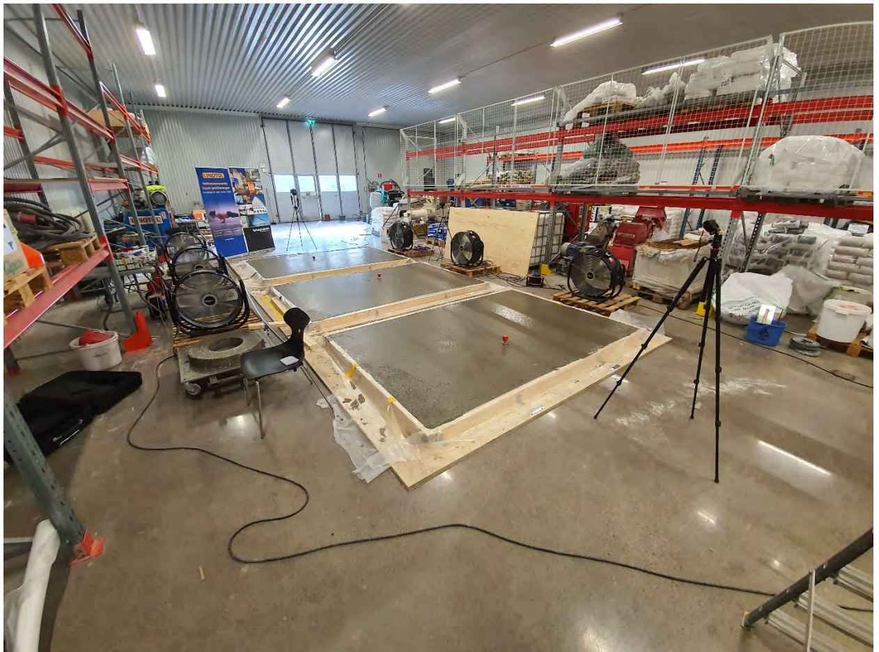
Figur 2.5 – Formarna efter gjutning vid halvskaleförsök. Utrustning för parallella ringförsök skymtar på sidan till vänster om plattorna.
