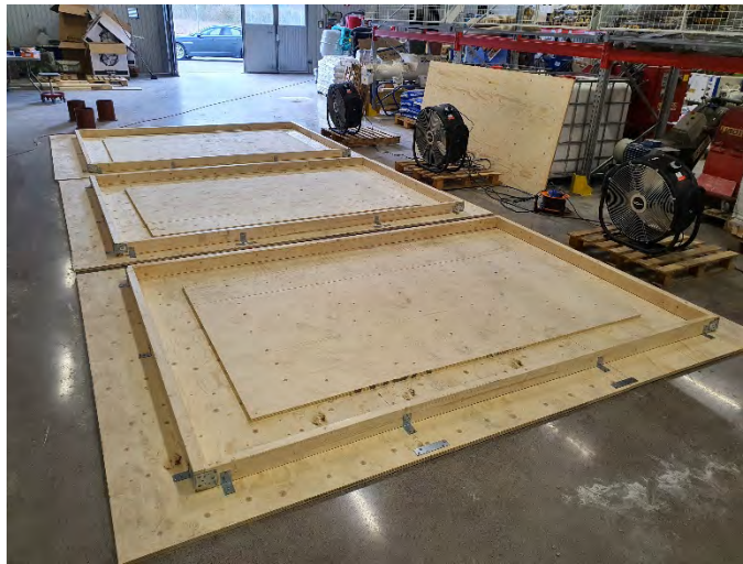
Figur 2.4 – Formarna före gjutning vid halvskaleförsök.
