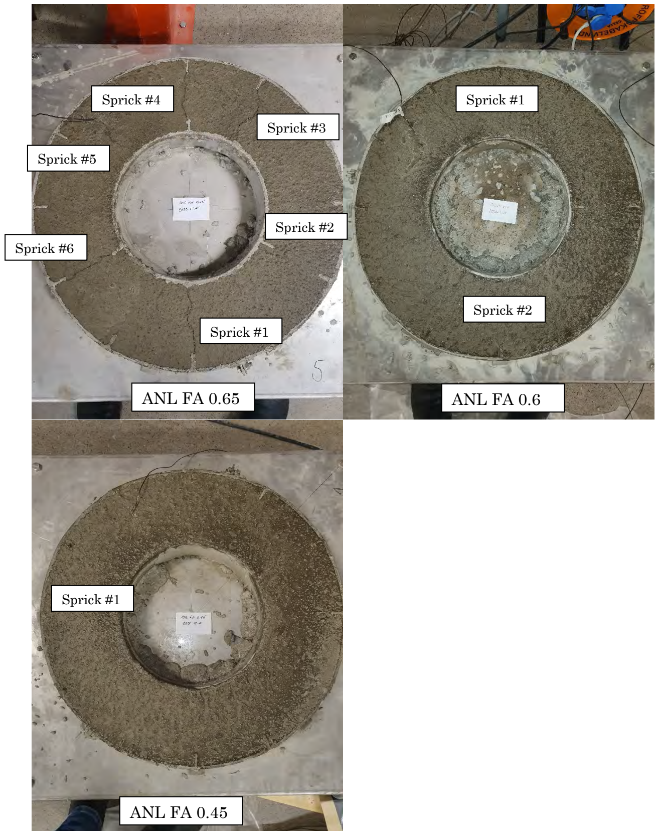
Figur 3.9 – Sprickor 24 timmar efter gjutningen i ring-test formarna – påverkan av vct.
