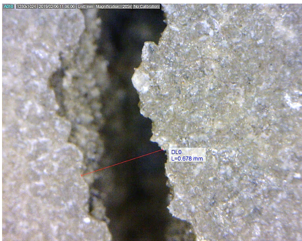
Figur 2.8 – Exempel på sprickbredden, mätt med Dino Lite AM-413T Pro digital mikroskop.
